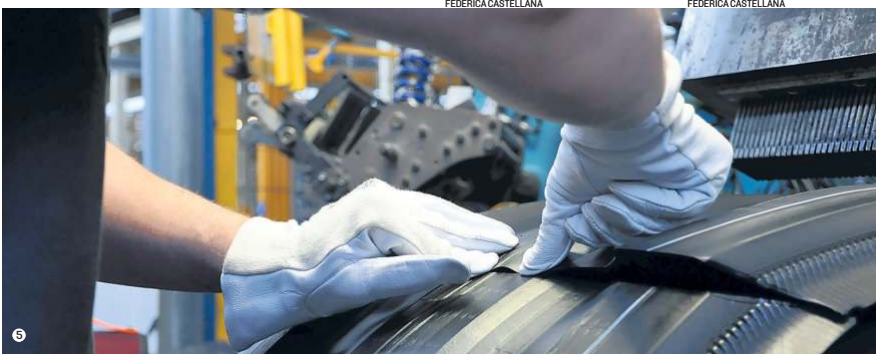
1. Lo stabilimento Michelin: robot per il rivestimento in gomma del cerchietto 2. Trattore La Cisa a propulsione elettrica all'ingresso 3. Il Bibendum Michelin 4. I partecipanti alla tavola rotonda. Da sinistra: Simone Rossi, Elisabetta Pittaluga, Giacomo Bargelli, Federica Moschini, Fabio Petrucci, Leonardo Marchese 5. Saldatura del battistrada a crudo 6. Passaggio di consegne tra Simone Rossi e Michele Guala, ad di Gualapack, che ospiterà il prossimo anno l'evento «La fabbrica sostenibile» 7. Simone Miatton, presidente e ad di Michelin Italia
