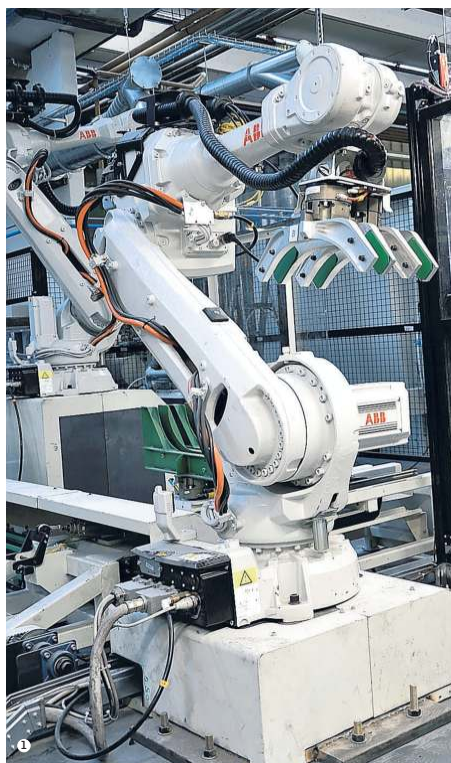
1. Lo stabilimento Michelin: robot per il rivestimento in gomma del cerchietto 2. Trattore La Cisa a propulsione elettrica all'ingresso 3. Il Bibendum Michelin 4. I partecipanti alla tavola rotonda. Da sinistra: Simone Rossi, Elisabetta Pittaluga, Giacomo Bargelli, Federica Moschini, Fabio Petrucci, Leonardo Marchese 5. Saldatura del battistrada a crudo 6. Passaggio di consegne tra Simone Rossi e Michele Guala, ad di Gualapack, che ospiterà il prossimo anno l'evento «La fabbrica sostenibile» 7. Simone Miatton, presidente e ad di Michelin Italia
